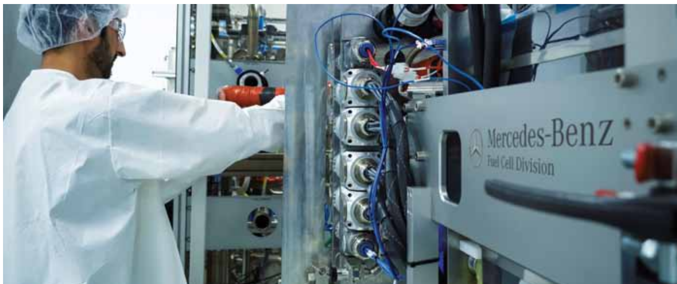
Technicien procédant à un test de validation à l'usine de production de piles à combustible de Mercedes-Benz, à Burnaby, en Colombie-Britannique.
